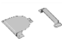
Pinsluitingen: Sluitingen met een flap welke over een uitstekende pin past.
